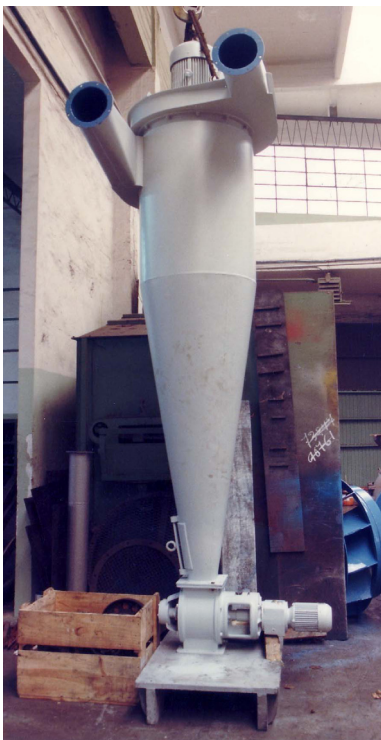
Ciclón con ventilador y válvula dosificadora de descarga
