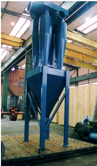
Grupo ciclónico compuesto por 4 ciclones, tolva común de descarga y patas de apoyo.
