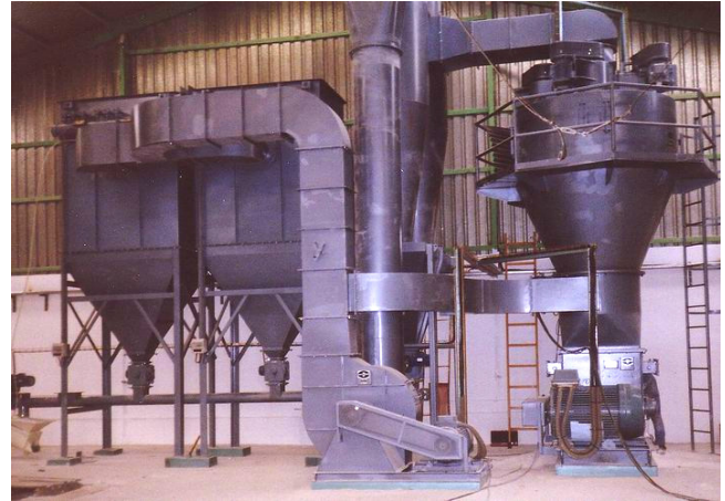
Molino MS 105-M1/4 para producción de altas finuras.
