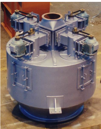
Detalle y fotografía de un clasificador para altas finuras.
