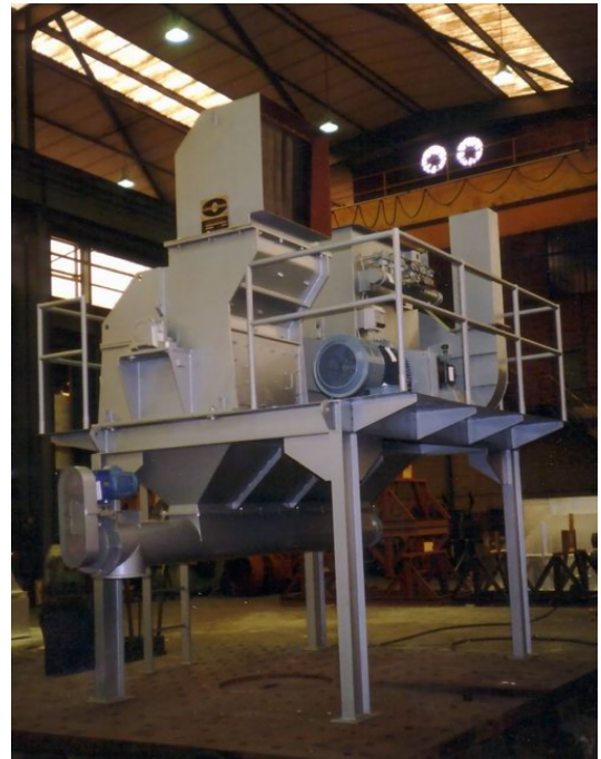
Molino de martillos MM10 sobre plataforma y sin-fin de descarga, con equipo de captación de polvo, compuesto por: filtro de mangas y ventilador.
