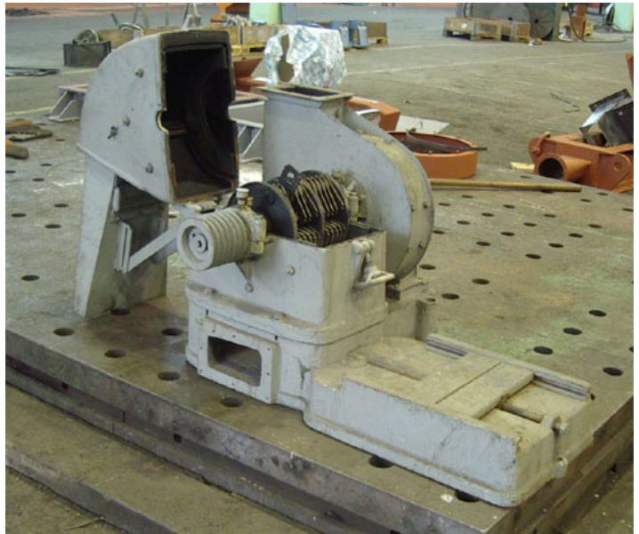
Molino AGRIDELTA 2-A y ventilador sobre bancada de transporte neumático
